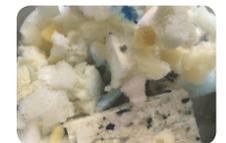
**Le rembourrage** d'un canapé est broyé pour servir de combustible dans les cimenteries.
